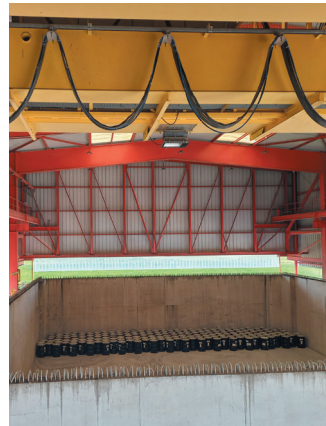
Bloc de béton en train d'être rempli de colis radioactifs, par une grue portique coulissante à l'ANDRA CSA, mai 2022. Photo : EB.
